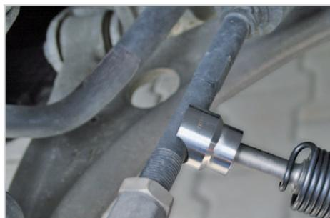
Preiswerte, gute Lösung zum Losvibrieren feststehender Fahrwerks- und Lenkungsteile.
