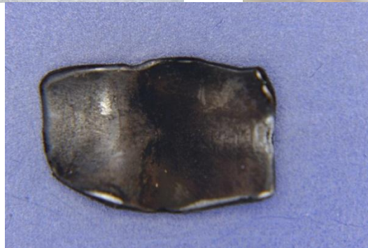
Beispiel für Bruchstücke aus einem Auspuffkrümmer
