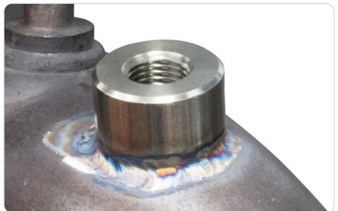
6. HJS Reperaturanschluß einsetzen und verschweißen.
