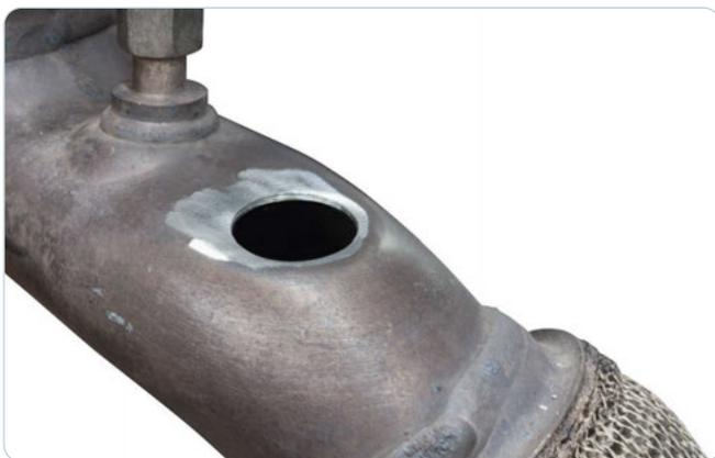
5. Bohrung entgraten. Bohrspäne sorgfältig entfernen.
