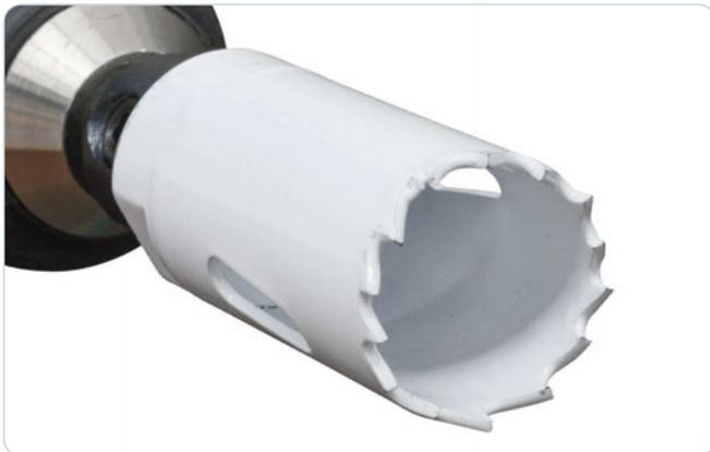
3. **Ausnahmslos Ø 25 mm Lochsäge ohne Zentrierbohrer verwenden**
