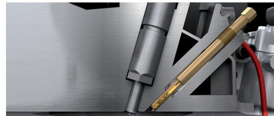
Vor dem Einbau neuer Glühkerzen sollten die Ölkohle- und Rußrückstände mit einer eingefetteten Reibahle aus der Glühkerzenbohrung entfernt werden.
