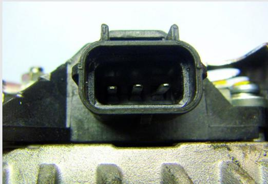
**Bei fehlerhafter Steckverbindung ist keine einwandfreie Kommunikation zwischen Generator und Motorsteuergerät möglich. Die Ladekontrollleuchte erlischt nur wenn alle 3 Pins am Generator eine fehlerfreie Verbindung zu den Steckzungen im fahrzeugseitigen Steckergehäuse haben!**
