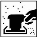
Oberfläche mit P1500 und einem 3mm Hub Exzentrerschleifer schleifen.
