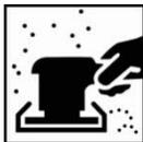
Oberfläche mit P3000 und einem 3mm Hub Exzentrerschleifer nachschleifen.
