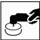
Poliermaschine mit AkzoNobel Pro NPM Professional Polishing Pad PLUS (orange) in Verbindung mit AkzoNobel Pro-NPM Professional Polishing Compound PLUS (orangene Kappe) verwenden.
