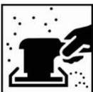
Mit Exzentrerschleifer 75mm und Schleifscheibe P3000 nass oder trocken nachschleifen.
