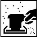
Staubeinschlüsse mit Schleifblüte P2000 und Schleifpilz oder Blütenschleifer trocken oder nass ausschleifen.
