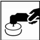
Schleif- und Polierbahnen immer 50% überlappend und sehr gleichmäßig zur nächsten Bahn ausführen. Darauf achten, dass der Untergrund nicht zu heiß wird.
