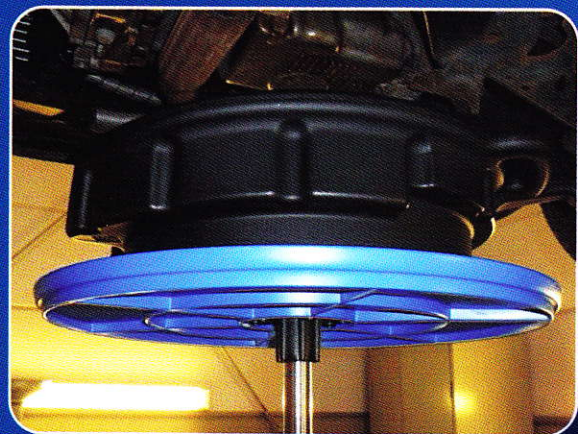
Abstellfläche für Auffangbehälter
