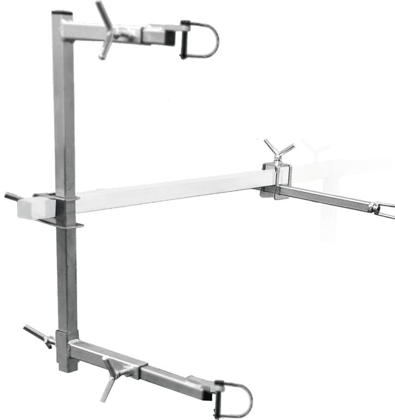
Der Halter wird am Drehlackierständer montiert und ermöglicht die Reparaturarbeiten von Fahrzeugtüren ohne die Innenverkleidung zu entfernen.
