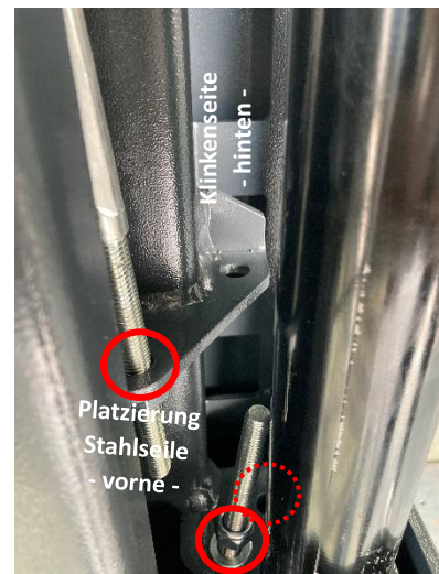
Abbildung Gegenseite von unten ohne Grundplatte. Roter Kreis markiert Bohrung in der Platte im Hubschlitten.
