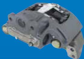
**Bremssattel inklusive Bremsträger und Bremsklötze (Pads)**
