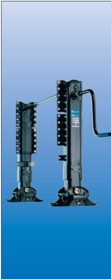
Stützwinden der Baureihe MODUL B sind außerordentlich vielseitig. Durch die modulare Bauweise mit der universell einsetzbaren, verstärkten Anschraub-Doppelplatte, verschiedenen Kurbeln und Verbindungswellenlängen sowie fünf Fußvarianten kann fast jeder Stützwinden-Anforderung mit 24 t Hublast entsprochen werden.
