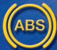
ABS :Verhindert das Blockieren der Räder bei Vollbremsungen und reduziert den Bremsweg bei gleichzeitiger Kontrolle des Fahrzeugs.
