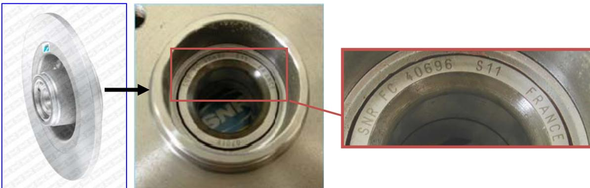
Quelle: SNR.- Original SNR Bremsscheibensatz inkl. Original Lager
