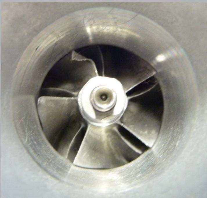
Wenn sich eine Schaufel des Verdichterrades umbiegt, wie auf diesem Foto zu sehen, sollte der gesamte Ansaugbereich geprüft und gereinigt werden.
